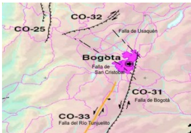
Figura 2.8. Fallas activas de la Región Central de Colombia- Modificado de Paris, G. y otros 2000. Se señala la localización aproximada de las Fallas de Usaquén y San Cristóbal. Los segmentos CO-31 y CO-33 corresponden a las Fallas de Bogotá y Río Tunjuelito, respectivamente (ver texto).
